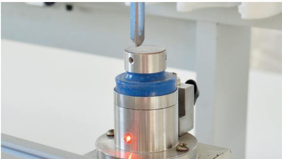
» Sensor de calibrado de herramienta
