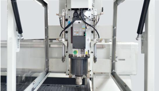
» Potente cabezal de fresado de 9kW
