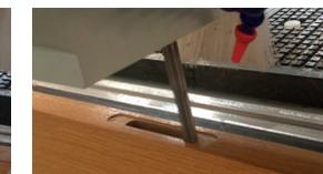
» Control numérico de 3 motores fresadores con soporte vertical para mecanizado de puertas (pernios y cerraduras). La solución que se adapta a todo tipo de trabajos tanto en paneles para su mecanizado tipo nesting con descarga automática, como el trabajo de carpintería tradicional para puertas y cercos.
