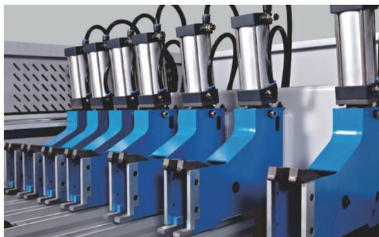
» Pinzas doble finger para asegurar la estabilidad. Mínimo tamaño de corte 34x45mm
