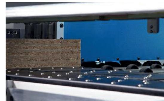
» Mesas móviles con cámara de aire para el fácil desplazamiento de los tableros
