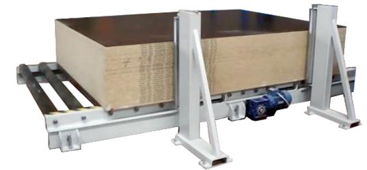
Vía lateral de rodillos (en modelos con plataforma)
