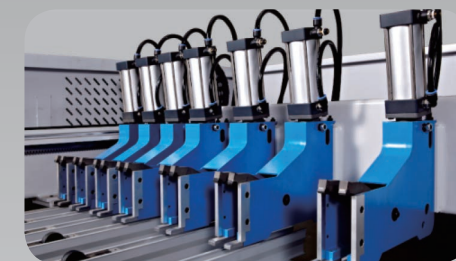
10 Pinzas doble finger: máximo agarre y estabilidad 10 Pinças duplo finger: aperto máximo e estabilidade
